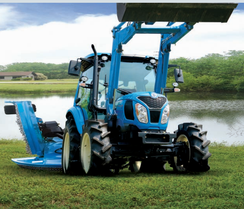
Un vaste champ de vision La conception du capot combinée à un large pare-brise et un toit ouvrant procure une vue dégagée avec un minimum d'obstruction.
