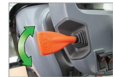
Inverseur hydraulique (modèle cabine)
